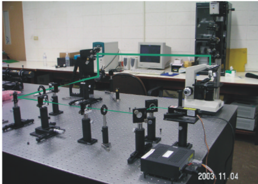
圖十一、光學鑷子實驗之實體儀器架設圖
